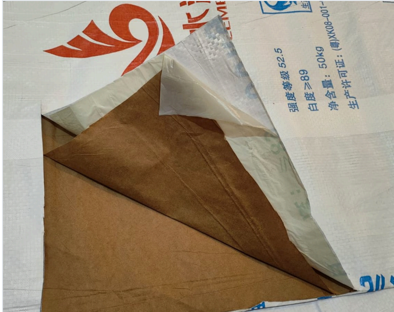
В разрезе: ламинированная ПП ткань, плёнка и крафт-бумага
