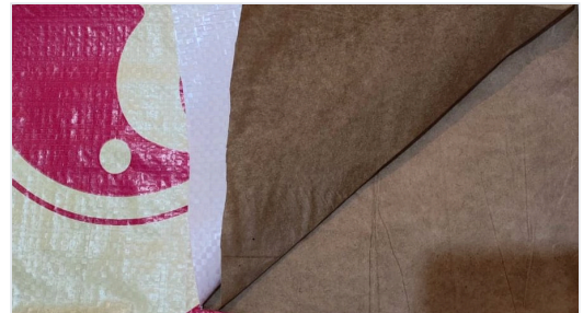
ПП мешок с печатью и слоем крафт-бумаги внутри
